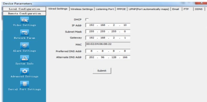
Gráfica 4-5 Configuración de conexión alámbrica
